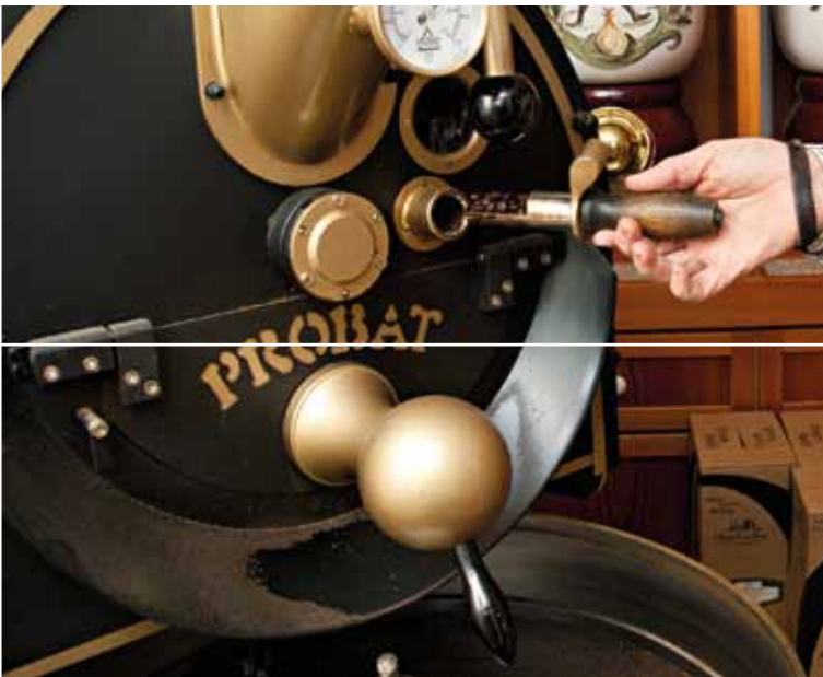
Foto links: 12 bis 20 Minuten werden die Bohnen in der Rösttrommel über der Gasflamme rasselnd gedreht und gewendet. Mit dem Probenzieher werden immer wieder einige Bohnen entnommen und so der Röstgrad überprüft.
