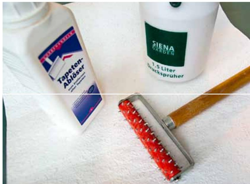
Kein mittelalterliches Folterinstrument, sondern praktisches Hilfsmittel zum Ablösen von Tapeten; durch die „Lochungen“ kann der Tapetenablöser besser eindringen. Wenn man zudem einen kleinen Drucksprüher verwendet, läuft einem nicht die Flüssigkeit in den Ärmel ...
